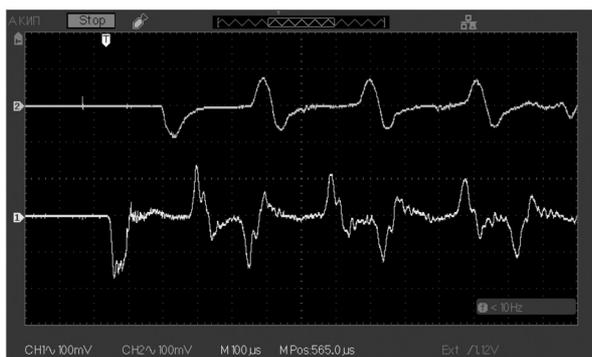
Рис. 3. Осциллограмма сигнала тензодатчика первого волновода (канал 1, нижний) и тензодатчика второго волновода через усилитель (канал 2, верхний)
