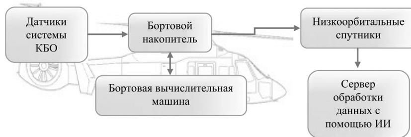
Рис. 5. Схема контроля состояния ВТ с применением ИИ
