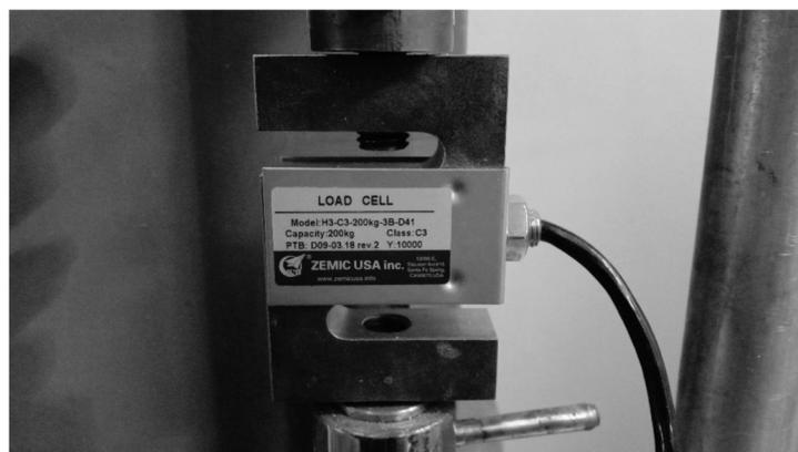
Рис. 2. Общий вид S-образного тензометрического датчика
