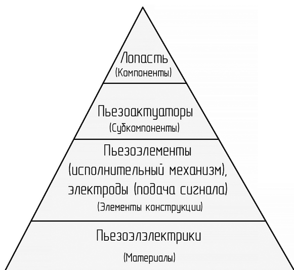
Рис. 8. Структурная схема конструктивной реализации SBC системы.
