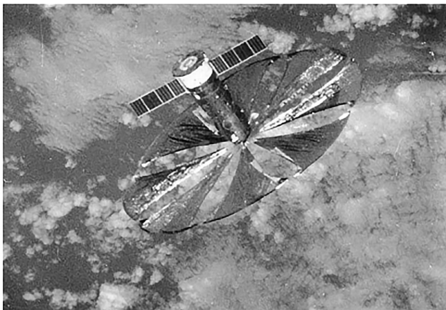
Рис. 26. Космический аппарат «Прогресс М-15» с развернутым солнечным парусом
