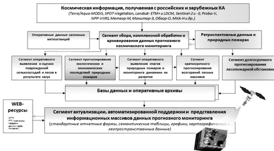
Рис. 3. Вариант структуры экспериментального участка прогностического космического мониторинга лесопожарной обстановки
