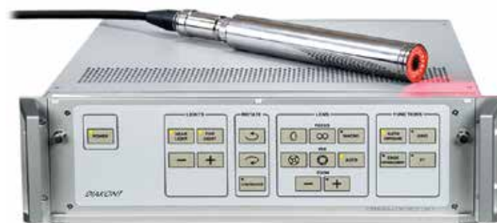
Радиационно-стойкая ТВ система CTC-40 М
