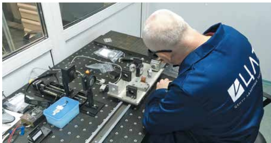
Юстировка резонатора лазера
