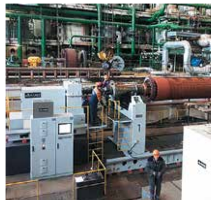
Модернизация балансировочного станка Ириклинская ГРЭС
