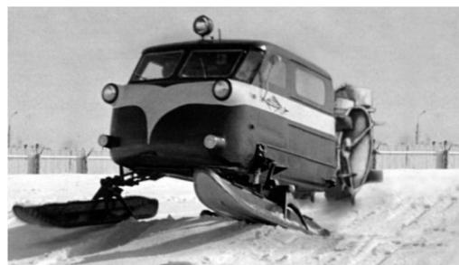
Рис. 7. «Общественный и индивидуальный транспорт» — сочлененные лыжно-поплавковые амфибийные аросани и лыжный снегоход с движителем системы С. С. Вечкова
