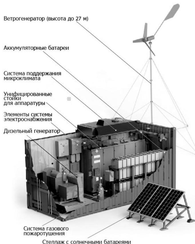
Рис. 1. Унифицированный автономный силовой функциональный модуль
