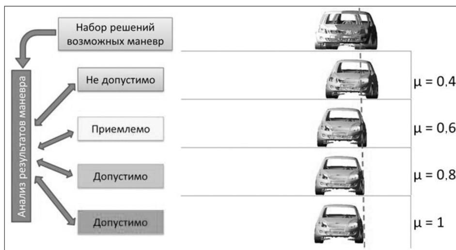
Рис. 3. Отклонение автомобиля от траектории при перестроении на скорости 100 км/ч при различных коэффициентах сцепления с дорогой
