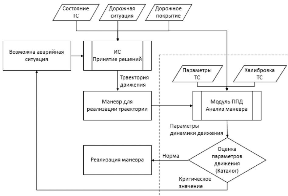
Рис. 1. Алгоритм встраивания модуля ППД в искусственный интеллект беспилотного автомобиля
