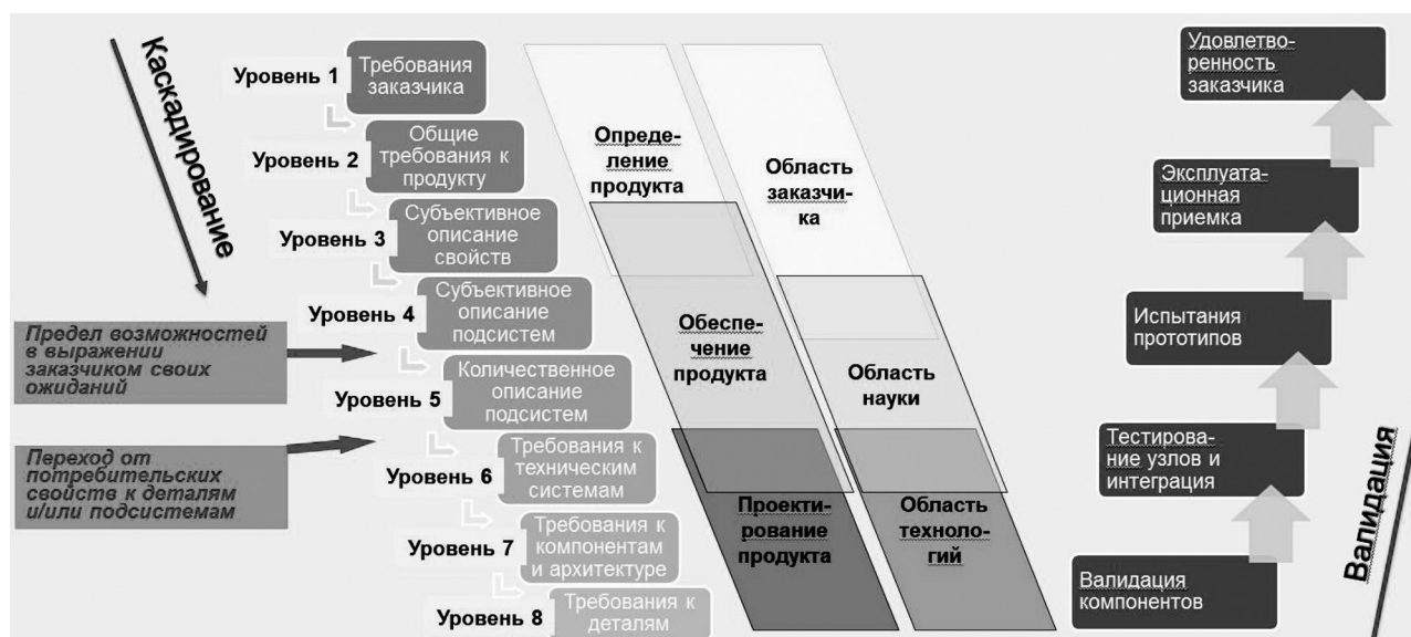
Рис. 1. Схема V-образного процесса проектирования
