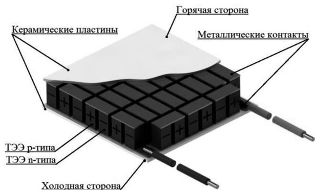
Рис. 2. Термоэлектрический генераторный модуль (ТГМ) в разрезе
