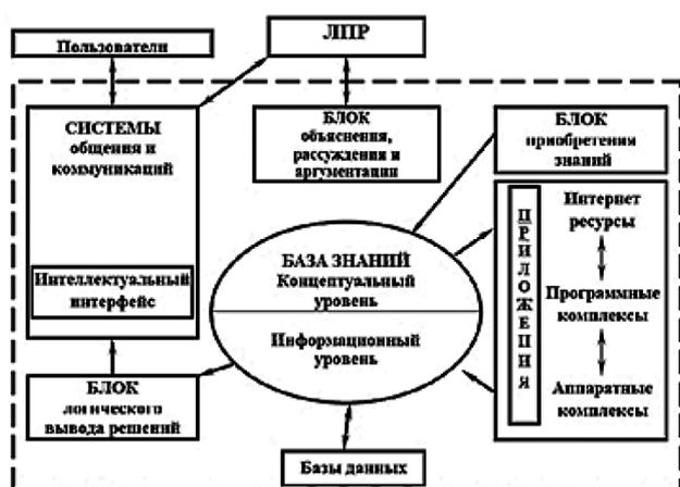
Рис. 4. Обобщенная схема ИИИС
