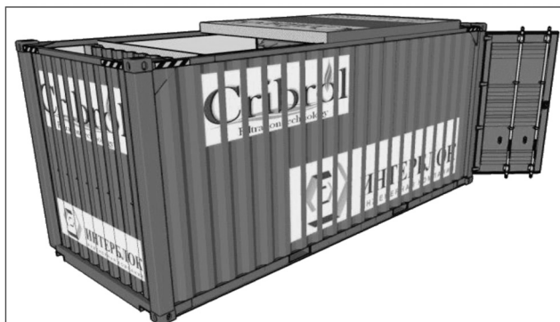
Рис. 2. Мобильный автоматизированный снего-, ледоплавильный комплекс «Криброд МАКС»
