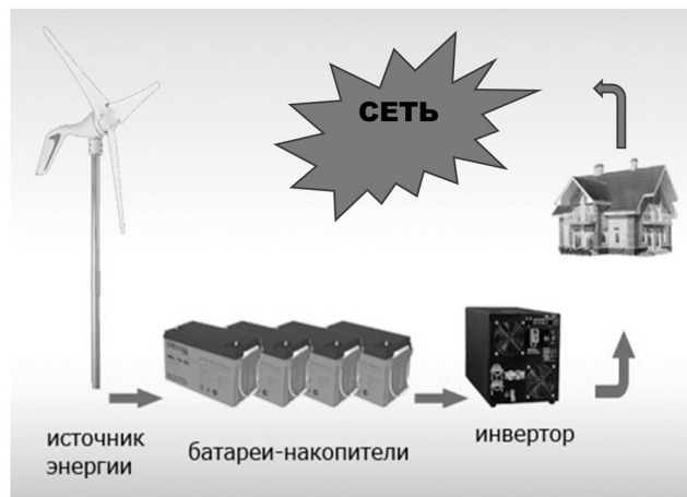
Рис. 2. Система «энергопотребления» (производитель=потребитель – сеть)
