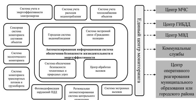
Рис. 1. Концептуальная схема построения аппаратно-программного комплекса «Безопасный интеллектуальный город»
