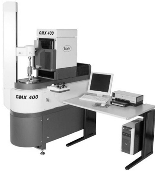
Рис. 17. Зубоизмерительная машина GMX
