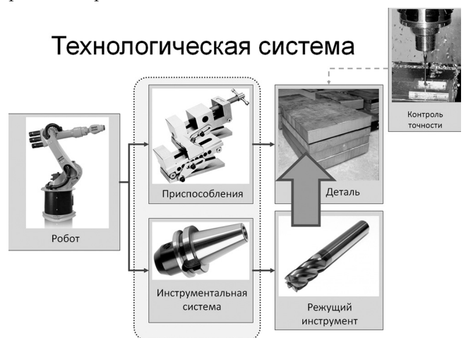
Рис. 6. Технологическая система роботизированной механообработки
