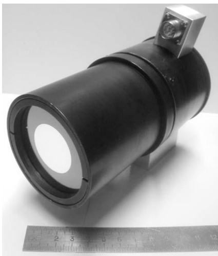
Двухспектральный пирометр (пирометр спектрального отношения) для быстродействующего измерения низких температур
