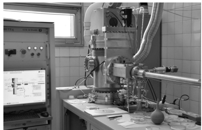
Установка плазмо-химического травления для проведения одной из операций постростовой обработки полупроводниковых пластин
