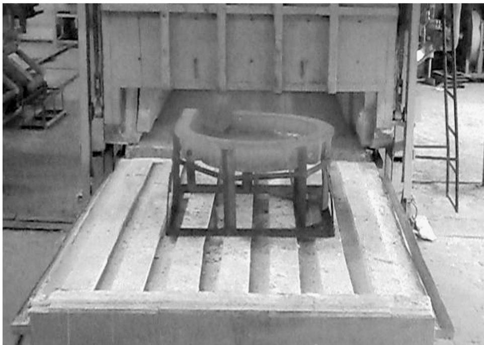
Высокотемпературный обжиг защитного покрытия
