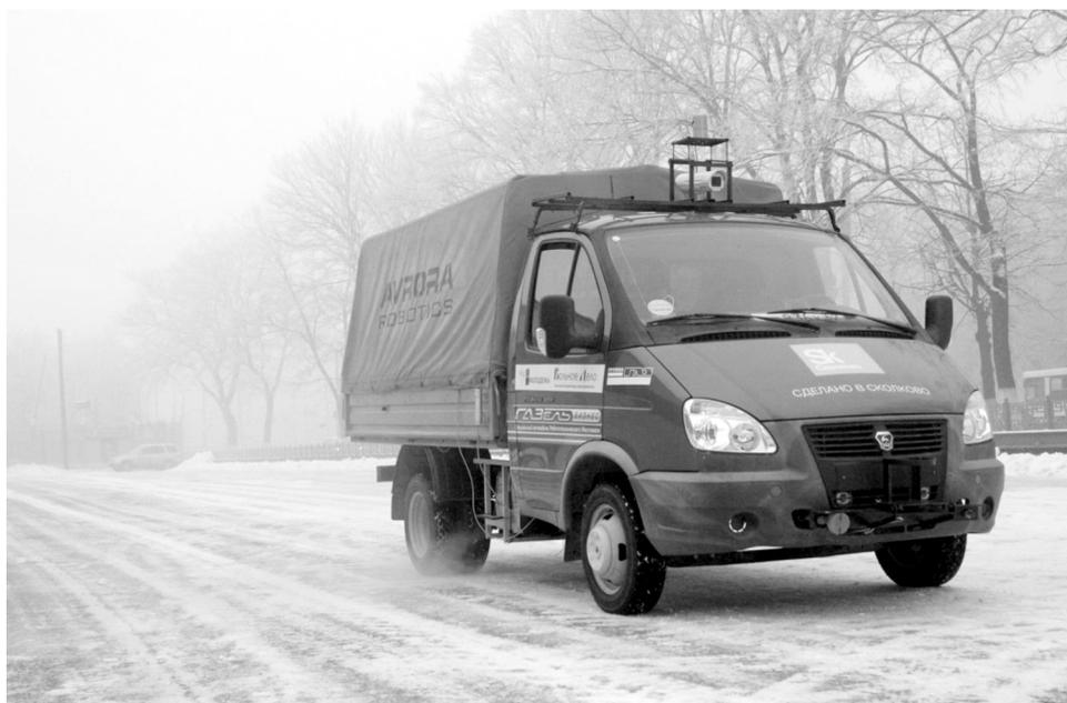
Рис. 1. Беспилотное наземное транспортное средство на базе автомобиля ГАЗель Бизнес
