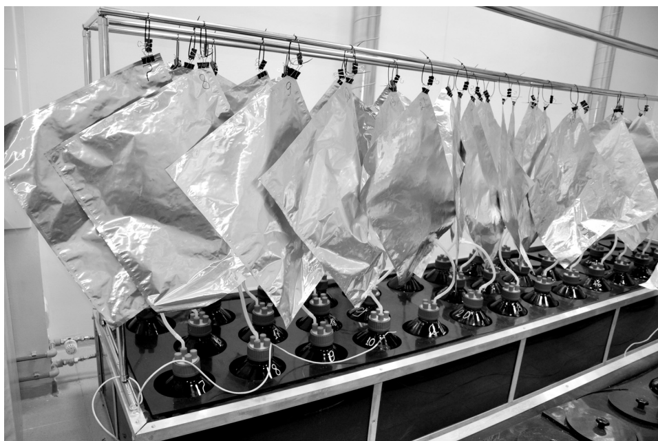
Рис. 4. В лаборатории Белгородского института альтернативной энергетики — лабораторная биогазовая установка
