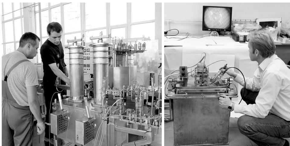
Экспериментальные образцы установок пирохимической переработки нитридного ОЯТ
