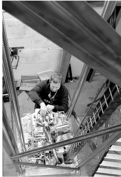
Приемочные испытания стенда инспекции на АЭС «Темелин» (Чехия).
