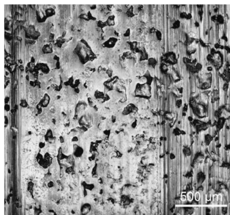
Рис. 4. Выполненный с помощью оптического микроскопа снимок следа износа обработанной стали 12X13 ( T = 120^\circ\text{C} , P = 1,5 ГПа, 10 млн циклов, скольжение–качение) [8]. Исследования выполнены совместно с ВАМ, Германия
