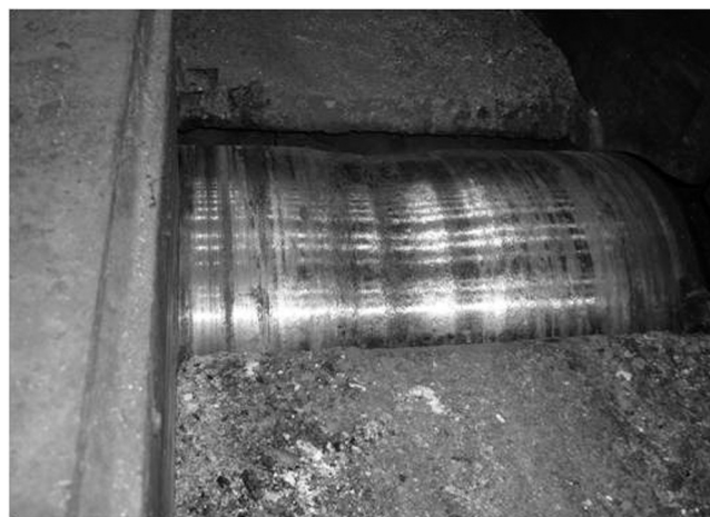
Рис. 8. Фотографии роликов рольганга прокатного стана металлургического комбината: слева — ролик рольганга прокатного стана с минеральным покрытием после 25 месяцев эксплуатации; справа — ролик рольганга прокатного стана без минерального покрытия после 8 месяцев эксплуатации (фото НПО «Геоэнергетика»)
