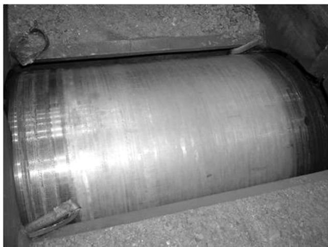
Рис. 8. Фотографии роликов рольганга прокатного стана металлургического комбината: слева — ролик рольганга прокатного стана с минеральным покрытием после 25 месяцев эксплуатации; справа — ролик рольганга прокатного стана без минерального покрытия после 8 месяцев эксплуатации (фото НПО «Геоэнергетика»)
