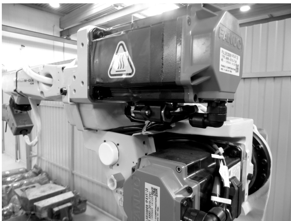
Рис. 10. Робот с головкой для создания минеральных покрытий в производственном цехе (фото НПО «Геоэнергетика»)
