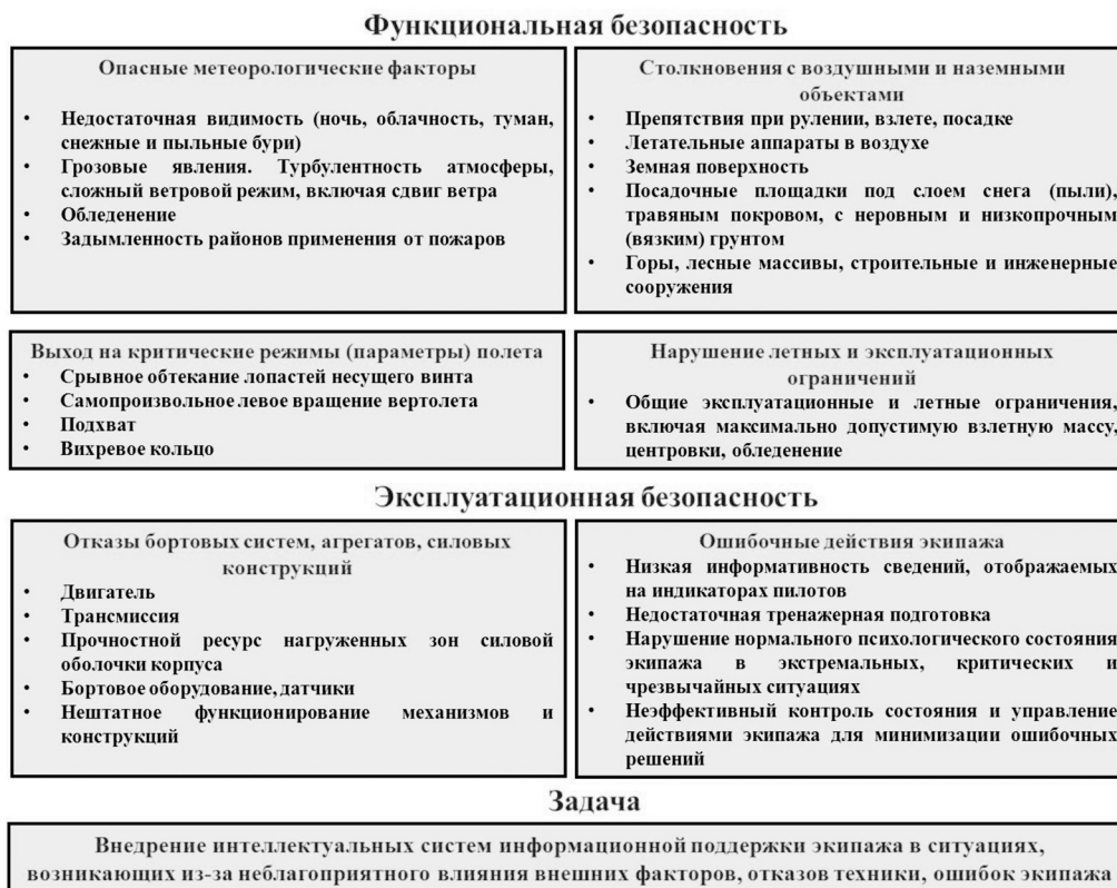
Рис. 1. Основные неблагоприятные факторы, парируемые системой обеспечения безопасности полета
