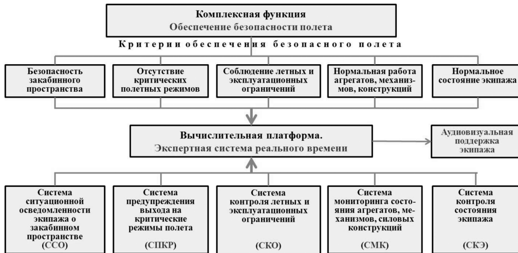
Рис. 3. Критерии и средства обеспечения безопасности полета
