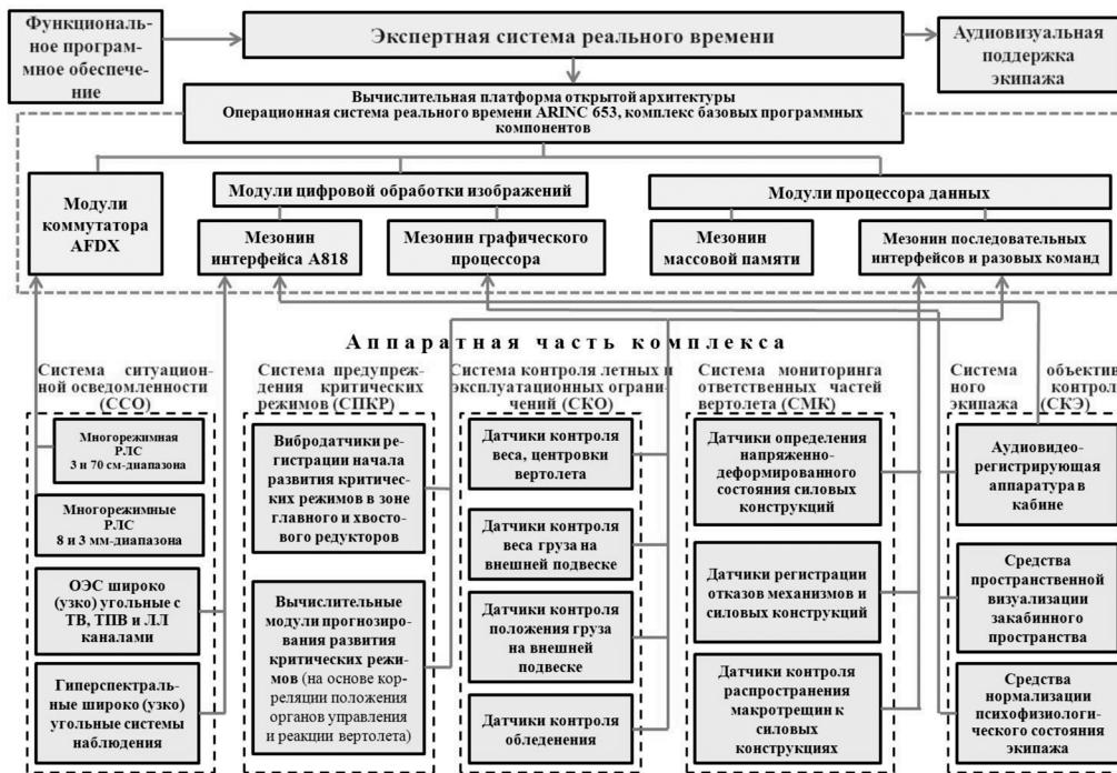
Рис. 4. Структурная схема перспективной ИСОБП вертолетов, реализованной по технологии ИМА как экспертной системы, функционирующей в режиме реального времени
