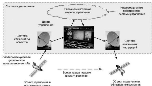
Рис. 4. Пример СТС со схемой цикла управления и сложной системной моделью
