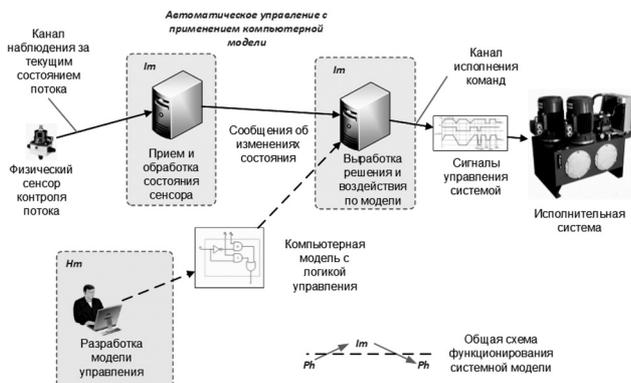
Рис. 3. Пример системы слежения по модели в режиме полной автоматизации
