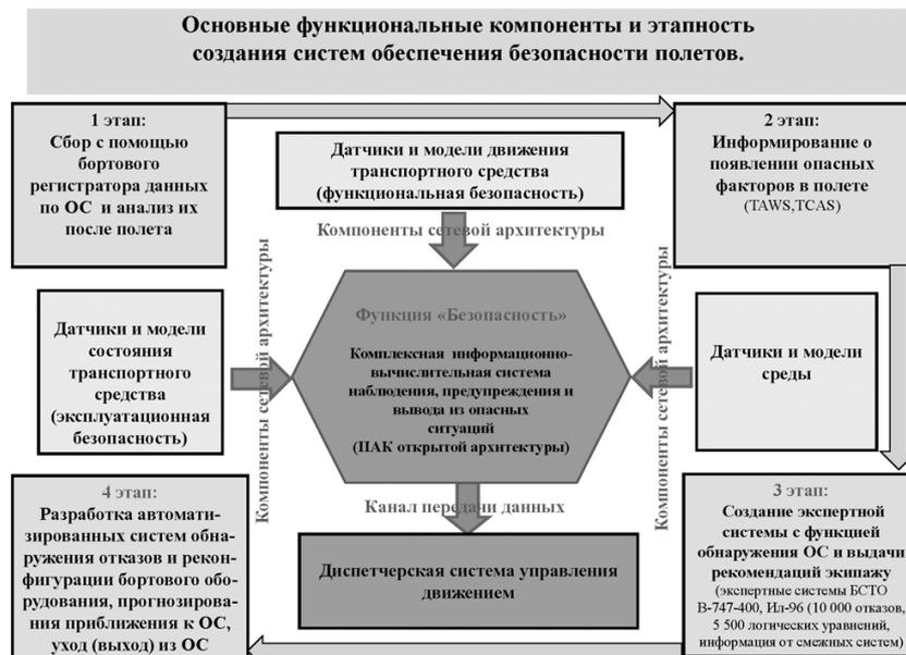
Рис. 4. Основные функциональные компоненты создания систем обеспечения безопасности полетов
