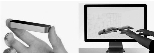
Рис. 3. Внешний вид и принцип работы контроллера бесконтактного управления LeapMotion
