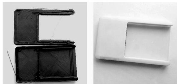
Образцы трехмерной печати корпуса низкого и высокого качества
