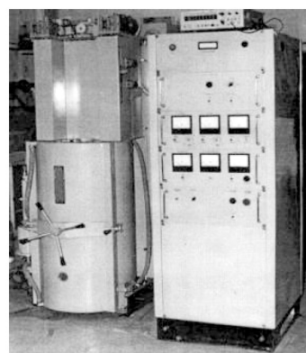
Рис. 7. Принципиальная схема (а) и установка «Кристалл-403» (в) для индукционной плавки в холодном тигле (мощность 160 кВт, частота 1,76 МГц, диаметр тигля 300 мм, длина 400 мм)
