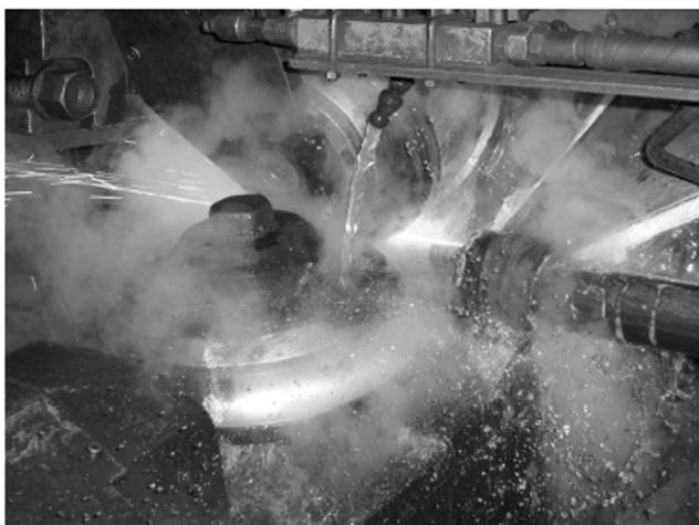
Рис. 4. Высокочастотная сварка труб с индукционным подводом тока к свариваемым кройкам
