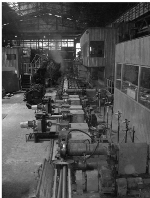
Рис. 7. Индукционная установка для подогрева труб перед редуцированием в линии ТПА-80
