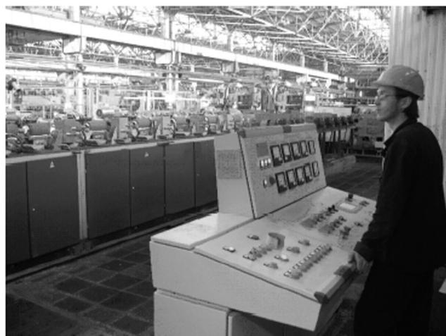
Рис. 6. Индукционная установка мощностью 3500 кВт в линии по производству арматуры
