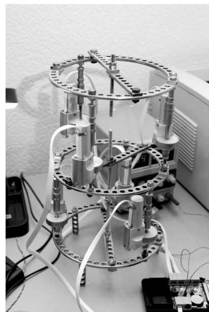
Рис. 2. Автоматические дистракторы с контроллером в аппарате Илизарова
