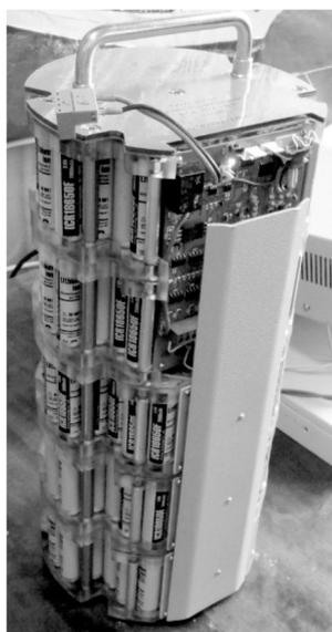
Рис. 6. Экспериментальная батарея 6ICR-58×3,4Ач
