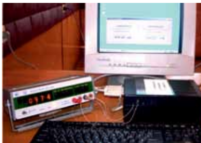
Измерительно-вычислительный комплекс повышенной точности с аналого-цифровым преобразователем
