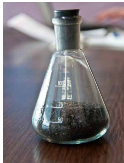
Получаемый порошковый сорбент для источников тока
