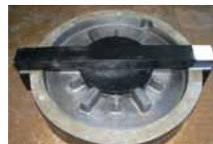
➤ Стержневой ящик к отливке «Щит подшивниковый»
