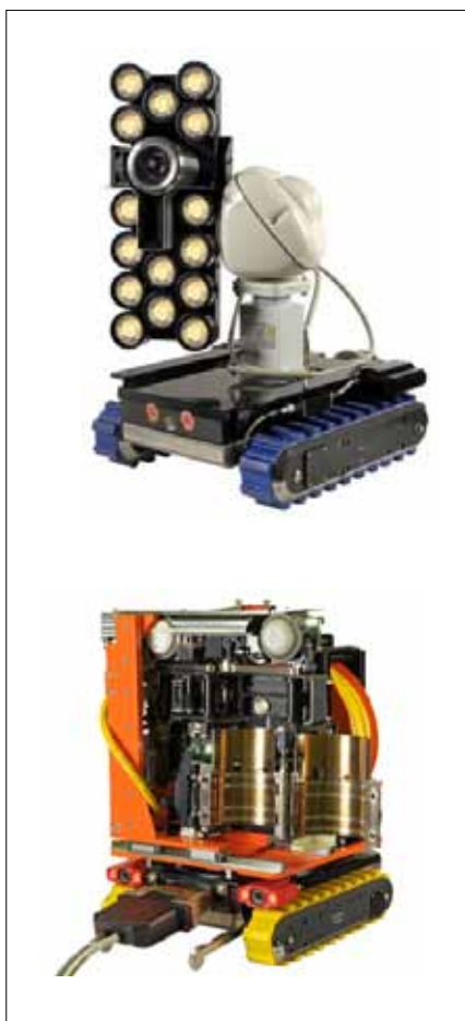
Роботы для диагностики и ремонта внутриреакторных конструкций
