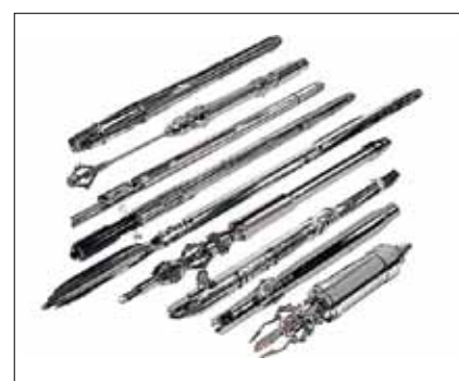
Оборудование, созданное ГК «Диаконт» для восстановления геометрии графитовых колонн реакторов типа РБМК-1000
