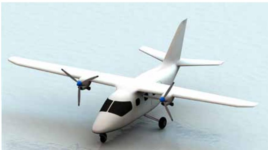
Рисунок — 9–11-местный самолет короткого взлета и посадки для местных воздушных линий Expedition.
