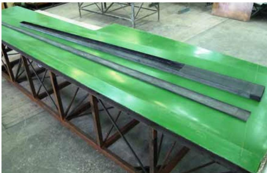
Элементы конструкции самолета из углепластика
