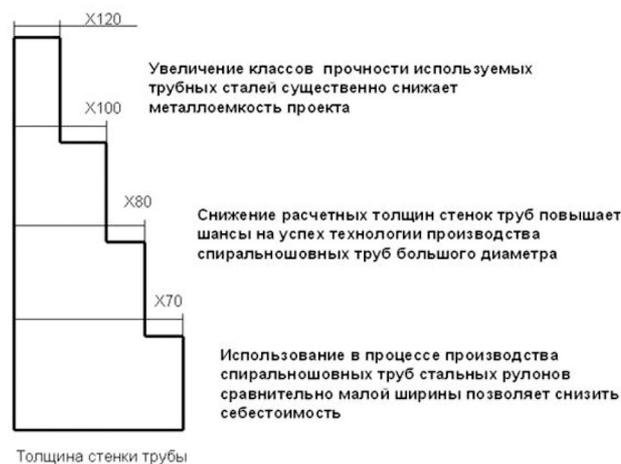
Рис. 1. Актуальность использования сталей высоких классов прочности для строительства магистральных трубопроводов
