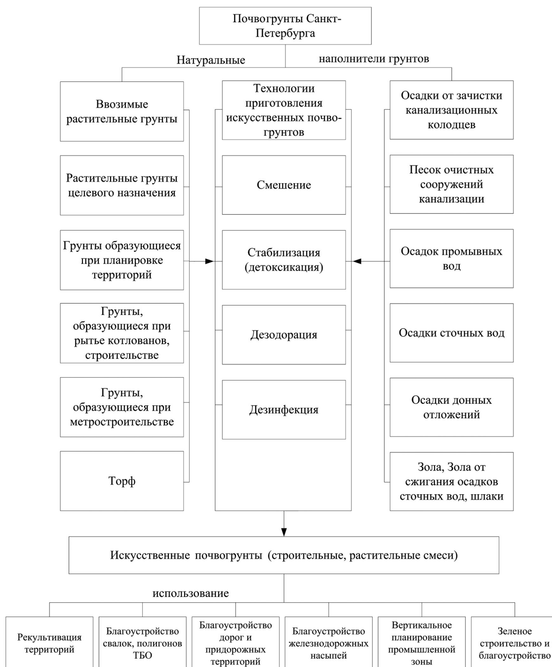
Рис. 1. Схема производства искусственных почвогрунтов (смесей)
