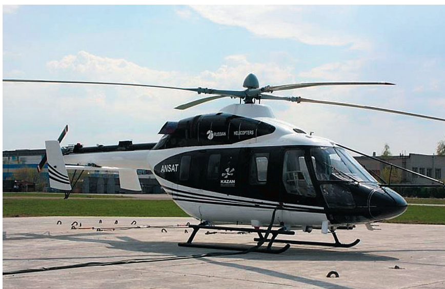
Рисунок 1. Опытный образец Ансата с гидромеханической системой управления
