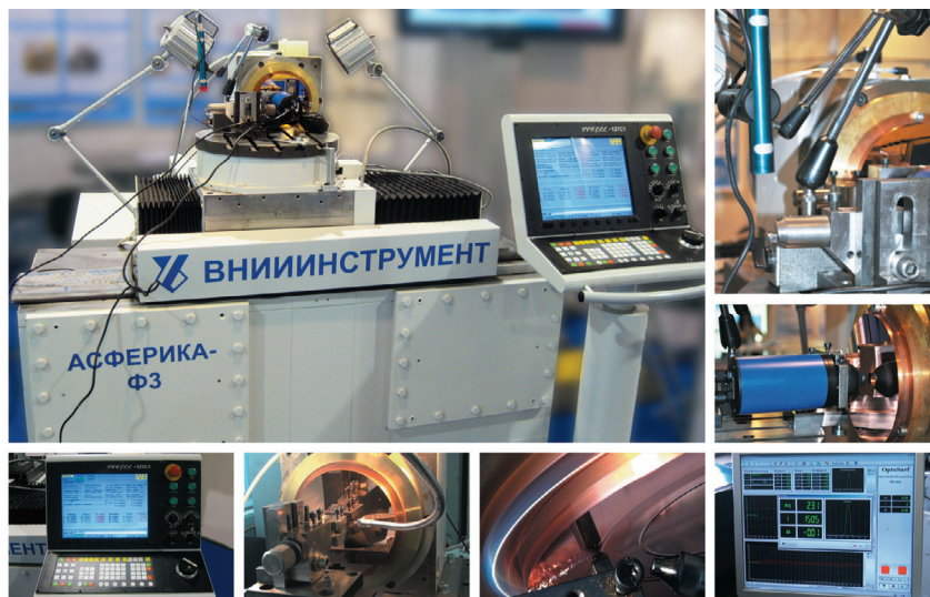
Рисунок 3. Ультрапрецизионный модуль для обработки асферических поверхностей «АСФЕРИКА-Ф3».
