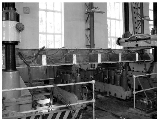
Рис. 4. Испытания натурного перекрытия длиной 7 м с тавровыми балками и трехслойным настилом из стеклопластика на изгиб по 4-точечной схеме
