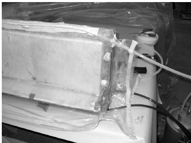
Рис. 2. Изготовление балки таврового профиля из стеклопластика методом инфузии
