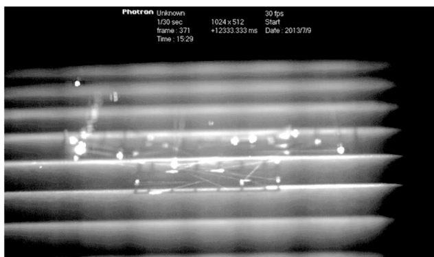
Рис. 7. Изображение, демонстрирующее многолучевую обработку при селективном электронно-лучевом плавлении образца из сплава ВТ6 (прогрев подложки до 750°C): наблюдается прогрев подложки и следы от высокоскоростного движения электронного луча (параметры съемки BCK Photron SA5: разрешение 1024×512 пикселей; частота кадров — 500 кадров в секунду; время выдержки — 1999,75 микросекунд)
