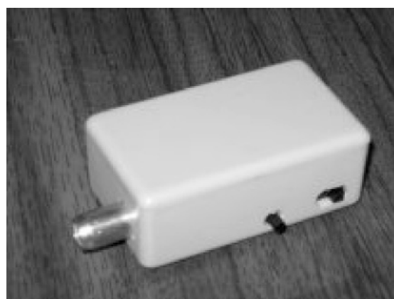
Рис. 8. Звуковой детектор уровня освещенности — индикатор работы светодиодов «Утро-01»
