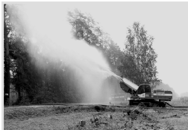
Рис. 2. Роботизированная установка газо-водяного тушения при постановке водяной завесы в зоне заражения
