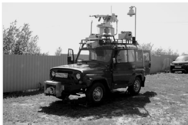
Рис. 6. Автомобиль с бинарной системой управления с элементами автономного управления на местности
