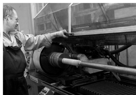
Рис. 5. Сальниковые уплотнительные кольца из нового углерод-углеродного материала и оборудование технологии намотки повышенной производительности
