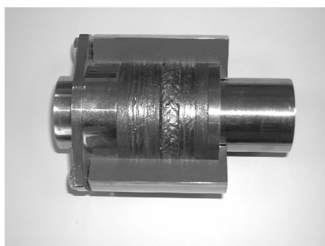
Рис. 4. Плетеные набивки для уплотнения и герметизации сальниковых камер
