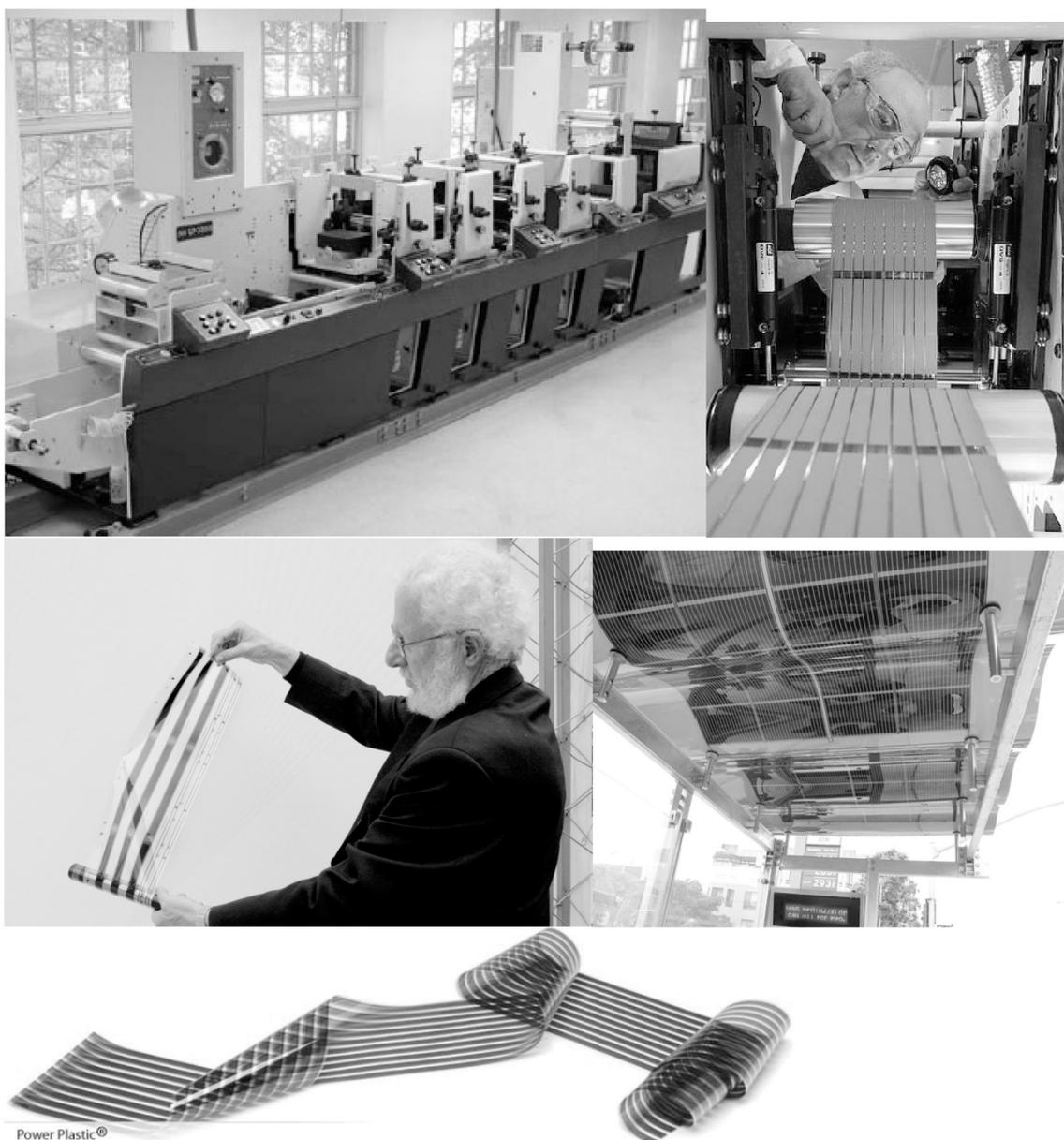
Рис. 14. Линия по нанесению СЭ на гибкие полимерные подложки с помощью холодной печати и струйных принтеров компании Konarka Technologies Inc.; Профессор Алан Хигер, Нобелевский лауреат по химии 2000 г. — соучредитель Konarka Technologies Inc. с продукцией компании; крыша автобусной остановки, покрытая полимерными СЭ (Konarka web page)
