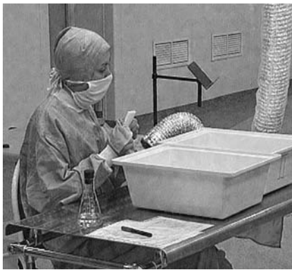
«Чистая комната» на НПК «Альфа», где в условиях полной стерильности производится сборка плазмодифильтров для очистки крови
