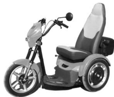
Трицикл — индивидуальное экологически чистое транспортное средство для городских и загородных поездок. Имеет беспередаточный электропривод на два задних колеса. Модификация, разработанная для инвалидов, снабжена регулируемым пневмокреслом, способным поворачиваться на 90 и 180 градусов. Источник питания — аккумулятор или конденсатор большой емкости.
