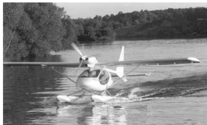
Недорогой высоконадежный двухместный самолет «Сигма-2» (разработан также четырехместный вариант) для спортивных и туристических целей. Конструкция может быть собрана из отдельных модулей за 2 часа. Предусмотрена замена колес на шасси поплавками или лыжами. Работает на бензине марки АИ-95, расход на 100 км — как у «Жигулей».
