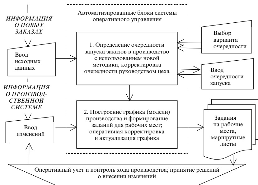
Рис. 7. Блок-схема компьютерной системы оперативного управления производством в предметно-замкнутом цехе
