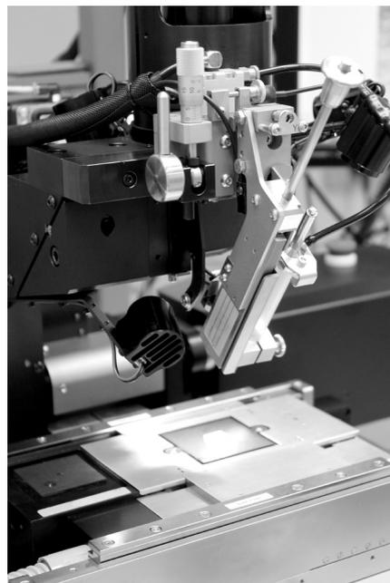
Станция установки кристалла интегральной схемы в корпус, применяемая в дизайн-центре
