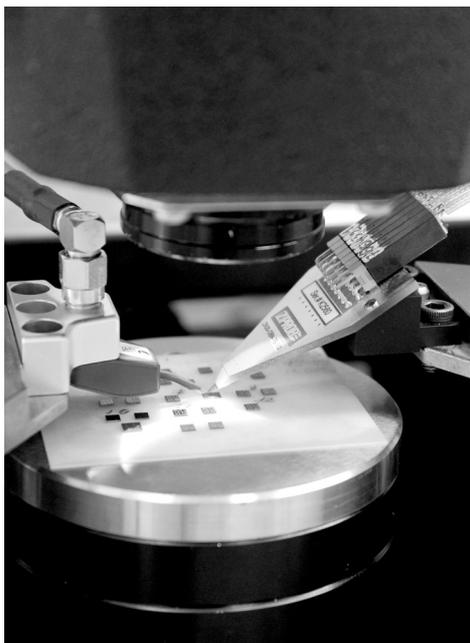
Зондовая станция для измерения параметров кристаллов интегральных схем
