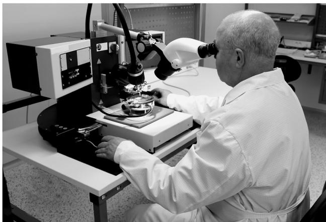
Разварочная станция (монтаж выводов на кристалл интегральной схемы) дизайн-центра АО «ВНИИРА»
